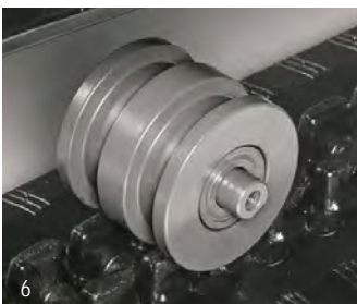
GALETS INFÉRIEURS À TRIPLES FLANCS
