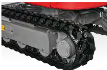
OUILLETS D'ARRIMAGE DU TRAIN DE ROULEMENT
