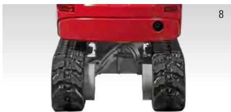
LARGEUR DU TRAIN DE ROULEMENT RÉTRACTÉ 750 MM
